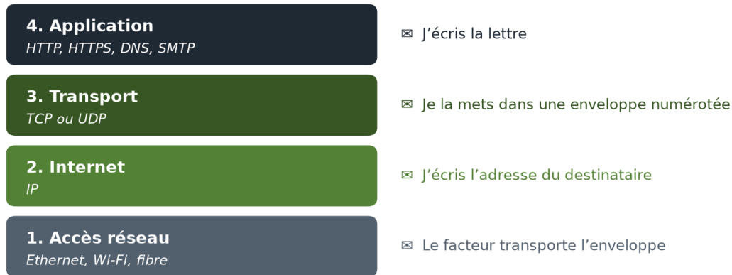
FIG. 8 Les 4 couches du modèle TCP/IP, comparées à l'envoi d'une lettre.
